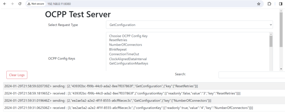
Şekil 3.5: OCPP Test Sunucusu Üzerinden Gelen Giden Mesajların Görüntülenmesi
